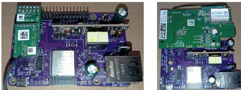
**Es darf niemals gleichzeitig eine Spannungsversorgung per USB (Netzteil oder Anschluss an PC) und über ein Netzteil am RPI-RF-MOD erfolgen, da es sonst zu Beschädigungen der Platine, oder der angeschlossenen Geräte kommen kann.**
