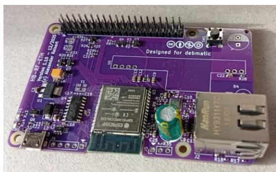
Optional bei PoE Erweiterung: Im Anschluss an den Zusammenbau des Basismoduls wird Kondensator C1 eingelötet. Auch hier ist auf die Richtung Polung zu achten. Es folgt die Diode D4. Diese muss vor dem Einlöten mit einer Spitzzange zuerst zurechtgebogen werden, auf die Polung muss dabei nicht geachtet werden, da es sich um eine bidirektionale Diode handelt:
