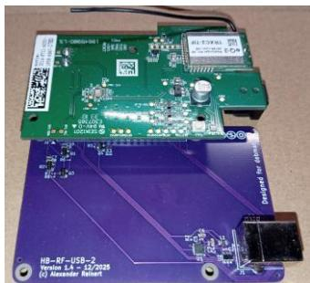
**Die Stromversorgung erfolgt per USB. Bei Verwendung des RPI-RF-MOD darf kein Netzteil an das Funkmodul angeschlossen werden, da es sonst zu Beschädigungen der Platine, oder der angeschlossenen Geräte kommen kann.**
